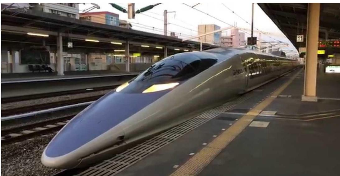
impatto quasi nullo sulla superficie dell'acqua e alla conformazione delle penne del gufo il quale arriva in velocità sulla preda senza fare con le ali il minimo rumore; così il 'muso' del treno è diventato simile al lungo becco del Martin pescatore mentre le ali del pantografo,
